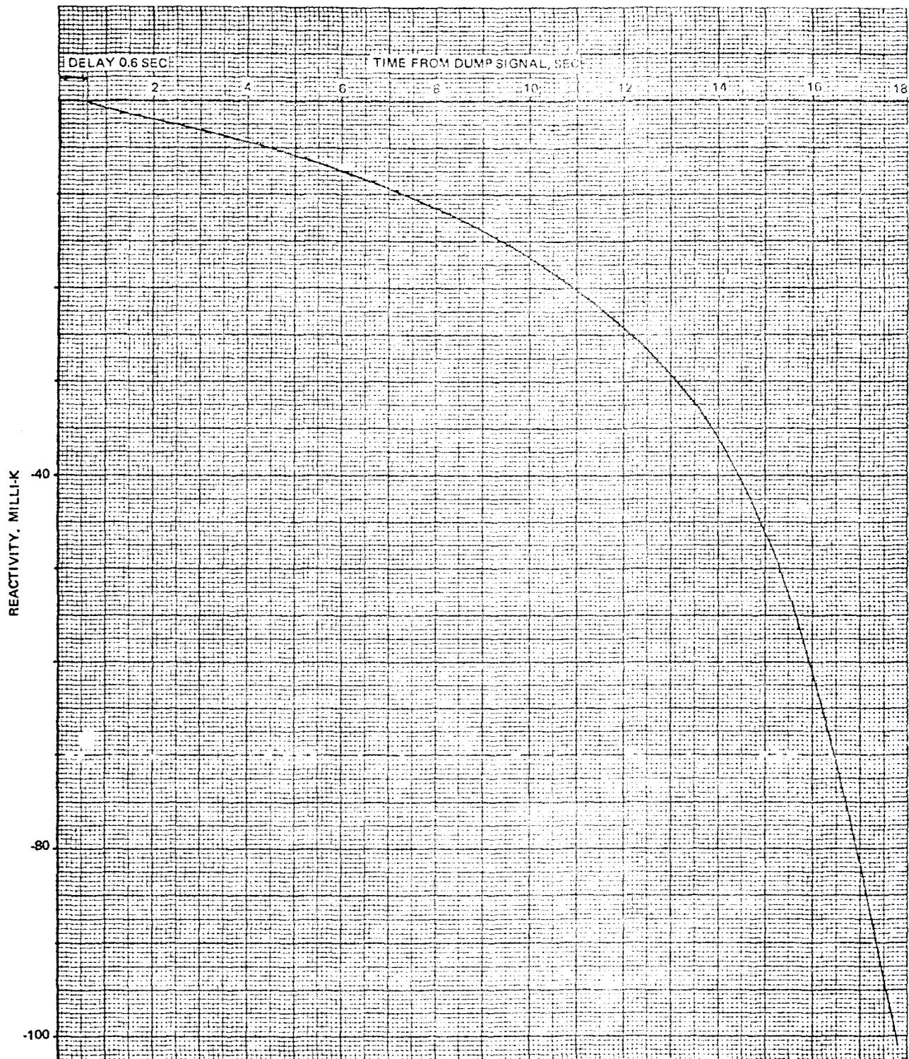
REACTIVITY VERSUS TIME FROM INITIAL MODERATOR DUMP SIGNAL
