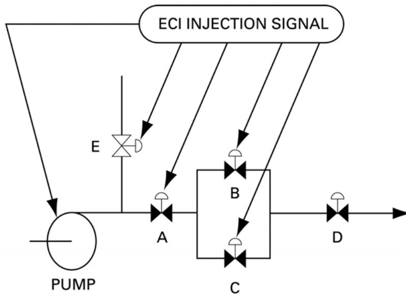
**FIGURE 5.1 – A SIMPLE EMERGENCY COOLANT INJECTION SYSTEM**
